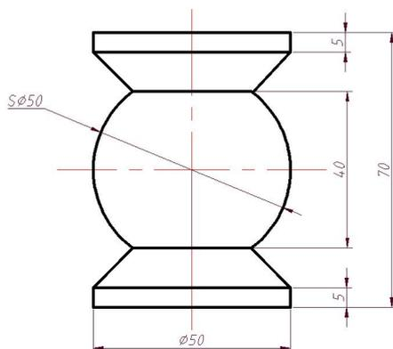
图 5 初赛搬运机器人搬运的物料形状
