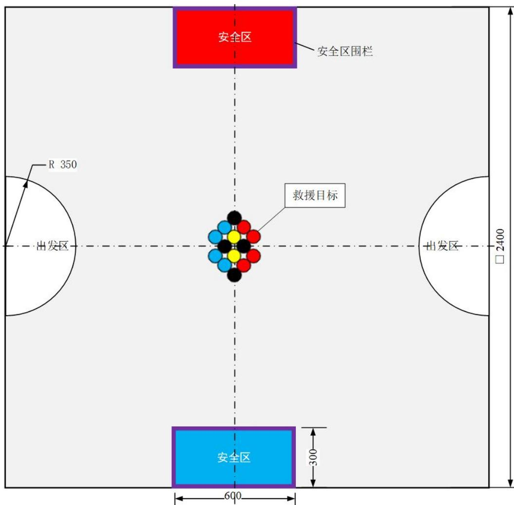
图 6 救援机器人现场运行示意图
